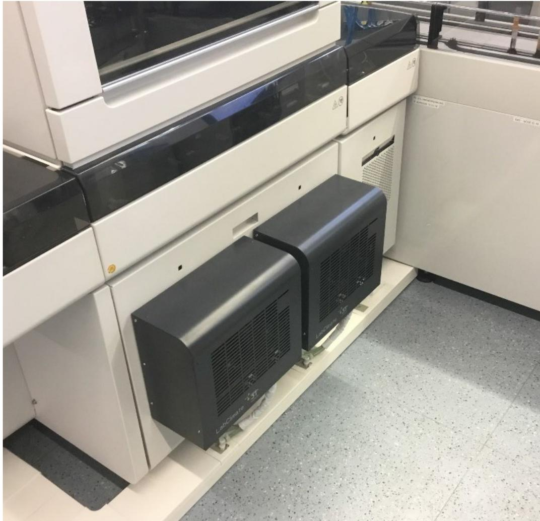
Mit speziellen **Wärmetauschern** wird die **anfallende Abwärme** abgeleitet und die Energie über ein flexibel verlegbares Schlauchsystem mit Wasser als Transportmedium abgeführt.
